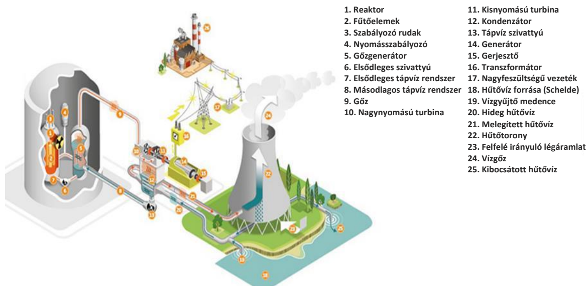
2. ábra: Az atomerőmű működése, balról jobbra a reaktorépület, a gépház és a hűtőkör (Forrás: Electrabel SA).
