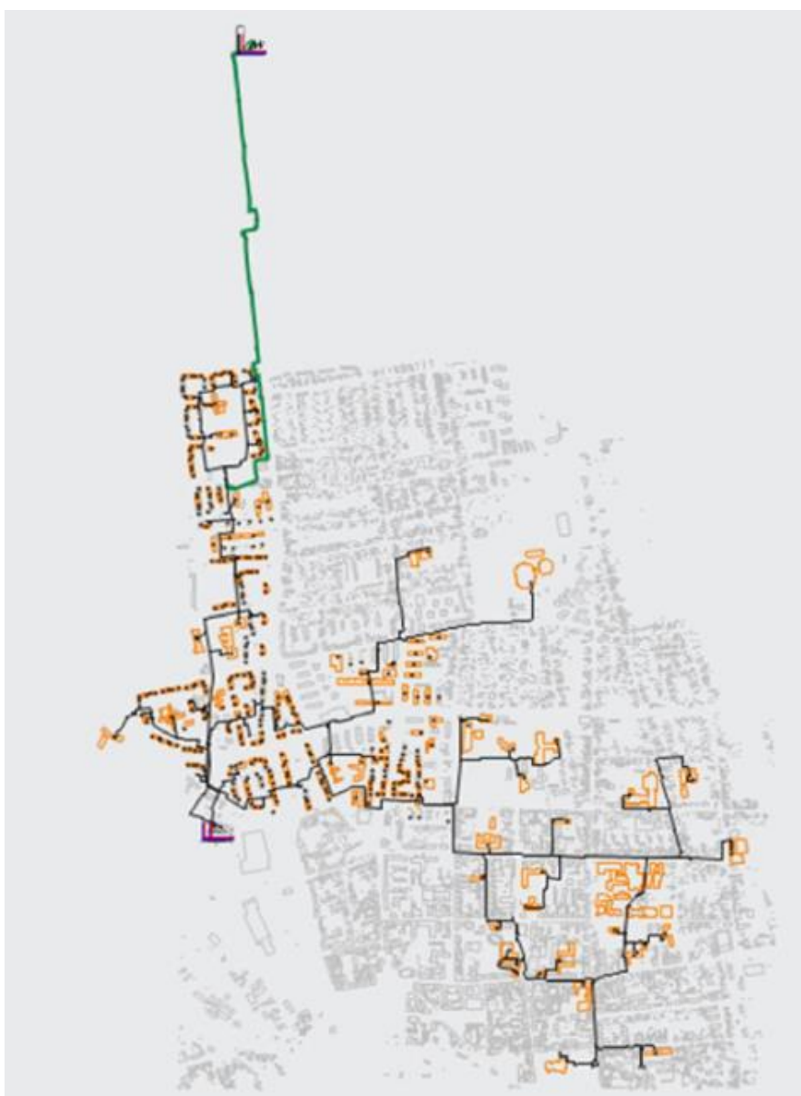
37. ábra A Zöld Fűtőmű távfűtési hálózatra csatlakozása (forrás: Kaposvári Vagyongazdálkodási Zrt. Távfűtési Üzeme)
