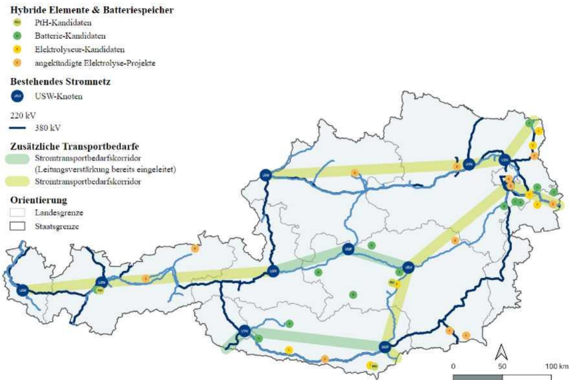
Ábra: A 2030-as átviteli hálózat villamosenergia-keresleti folyosói, kép: (Lehrstuhl für Energieverbundtechnik an der MU Leoben; Institut für (Institut für) Elektrizitätswirtschaft und Energieinnovation an der TU Graz, 2023)
