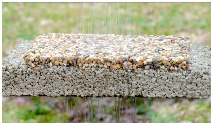
Áteresztő kőszőnyeg keresztmetszete – Forrás: www.drenatech.com
