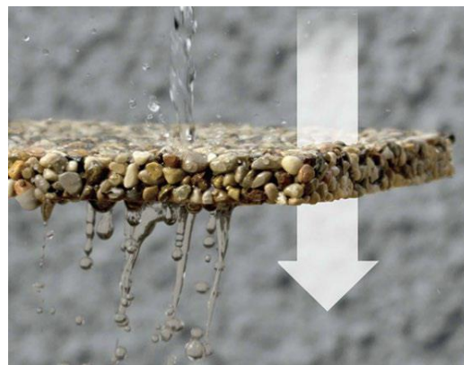
Áteresztő kőszőnyeg keresztmetszete – Forrás: www.drenatech.com
