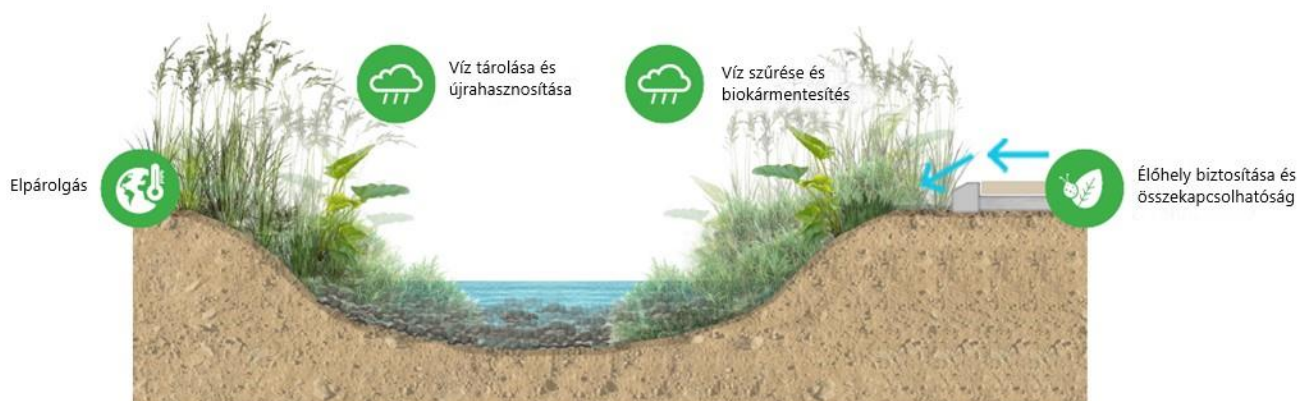
Egy biogödör keresztmetszete és annak a természetes folyamatai és előnyei –Forrás: UNaLab 16
