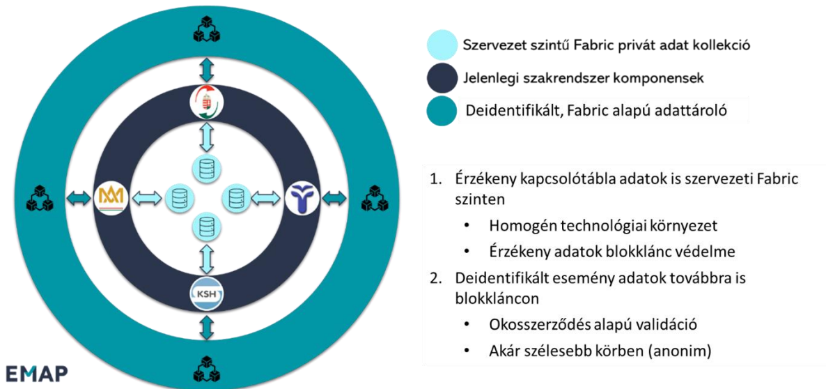
8. ábra: Hyperledger Fabric alapú EMAP Pilot architektúra rétegek
