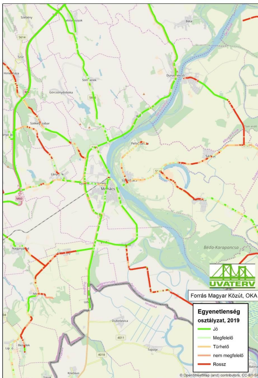
20. ábra: A szűk hatásterület közúthálózatának egyenetlenség osztályzata, 2019 [forrás: OKA]
