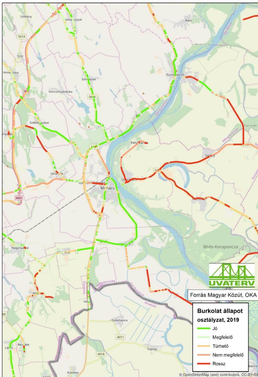
19. ábra: A szűk hatásterület közúthálózatának burkolatállapota, 2019 [forrás: OKA]
